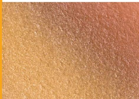
Le nouvel hybride. ENGOSYN®-R est un mélange de glaçure et d'engobe. Au lieu d'utiliser des engobes appliqués à sec pour certaines applications, il est désormais possible de traiter des particules grossières par voie humide.
